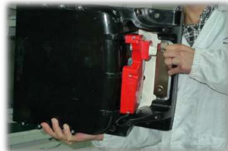
Силовая ячейка инвертора
