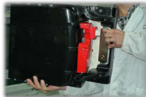
Силовая ячейка инвертора
