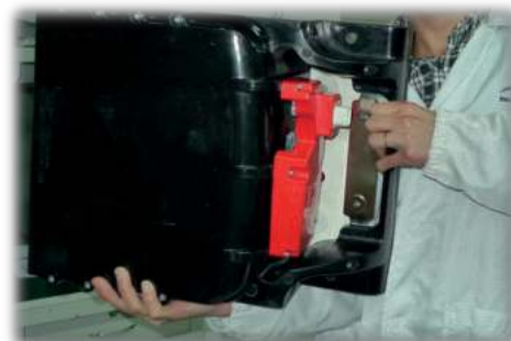
Силовая ячейка инвертора
